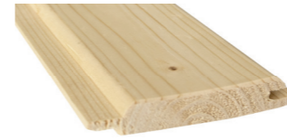
Profilholz Nord. Fichte, us/hobelfallend roh, Rundkante, lange Feder 14,5 mm, 15 x 96 mm
